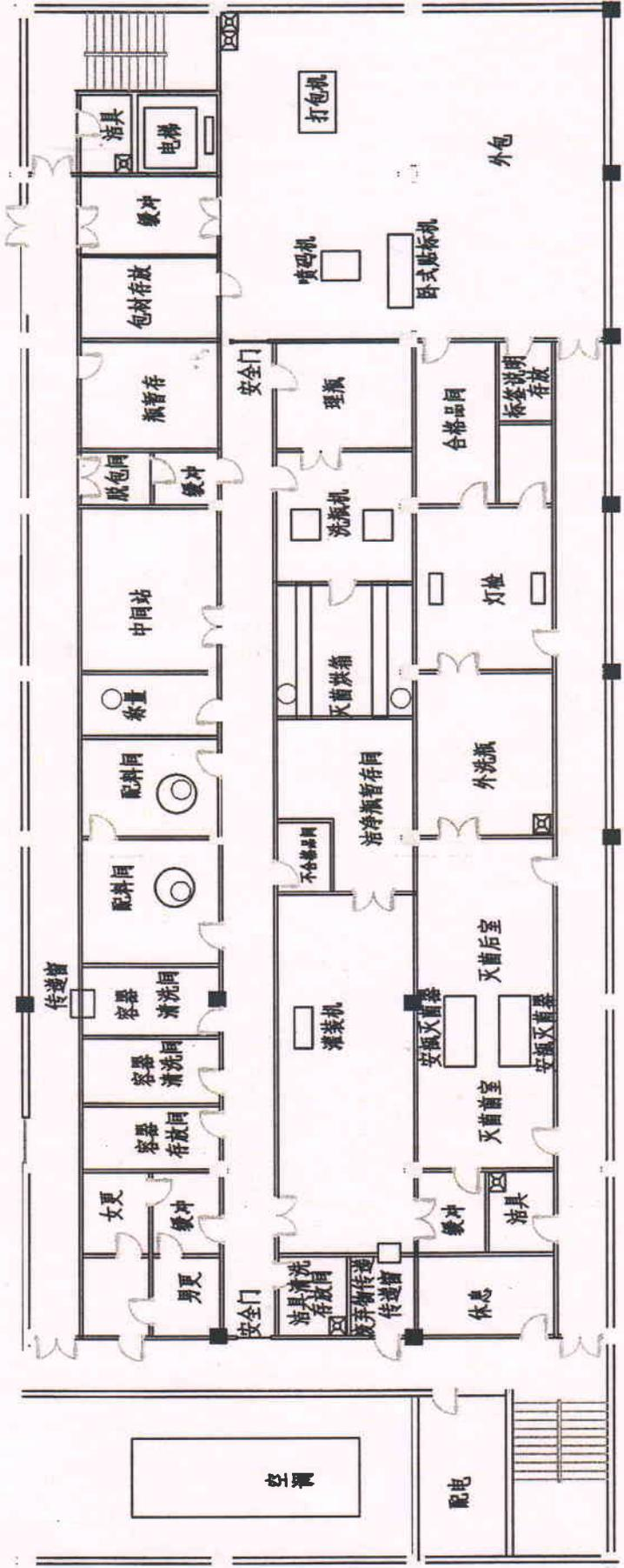
附图四 液体制剂车间平面布置图
