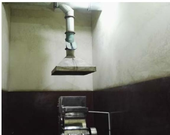
原料处理车间破碎工段集气罩
